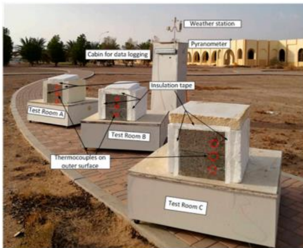
Figure 1.20. Schéma des blocs de béton, avec des couches de construction et la chambre d'essai
