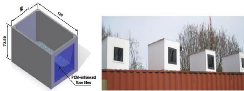
Figure 1.48. Test de cellules utilisées par l'Université de Twente, aux Pays-Bas, pour tester le plancher de sol avec MCP
