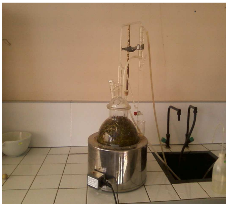
Figure 5 : Montage d'hydrodistillation (photo originale)
