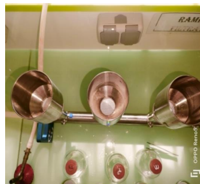
Figure 37 : Les rampes de filtration ( Benamar et benderdouch )
