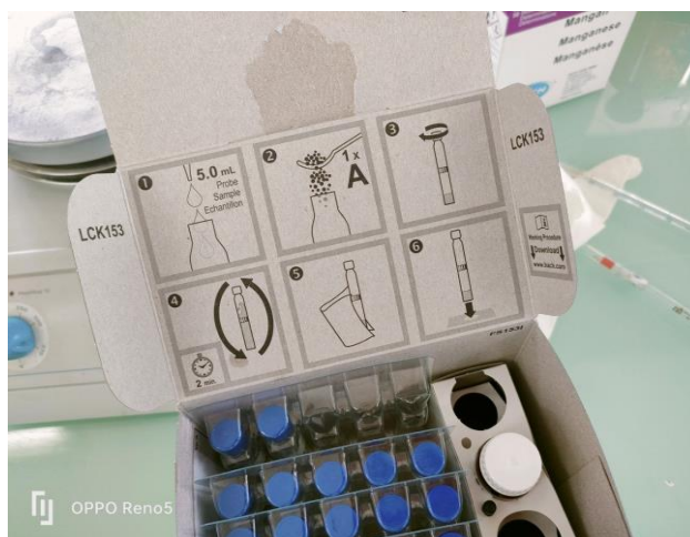
Figure 31: Photo montre les étapes de travail pour la mesure de sulfate (Benamar et benderdouch)
