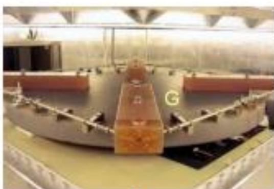
Figure III.14. Sismomètre rotatif, en anneau laser installé horizontalement
