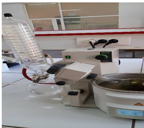
Figure 12 : Evaporation d'huile Appareil Rotavapor
