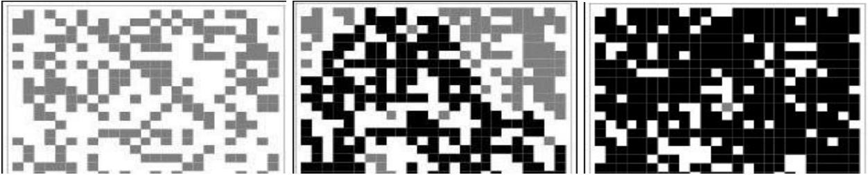
Figure (I.10) exemple de percolation sur un réseau carré de site pour différents « p » [13]
