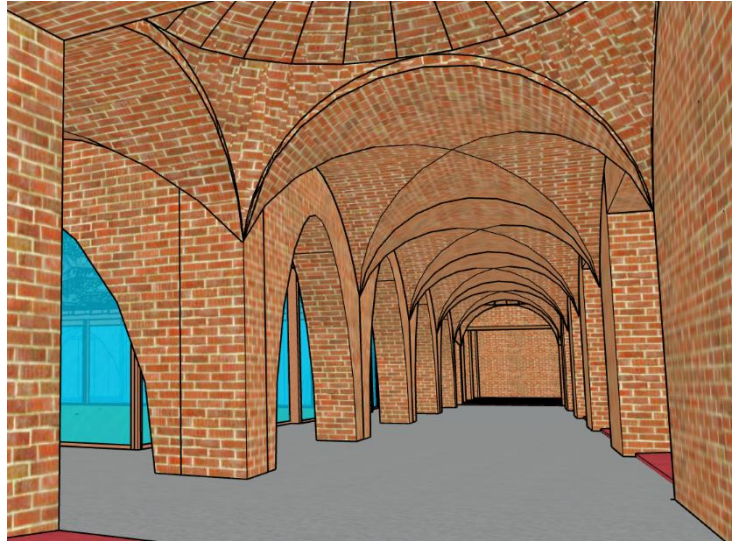
Figure 70 : Les voûtes d'arêtes
