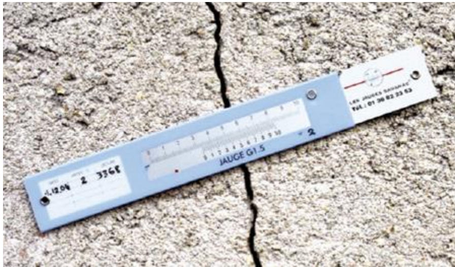
Figure I. 1. Règle de mesure de largeur de fissure (0,1 mm à 7 mm). Source : https://www.saugnac-jauges.fr .
