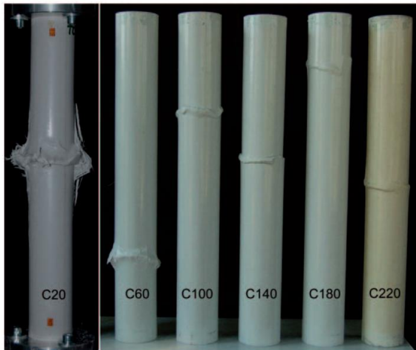
Figure III. 30. Mode de défaillance dans les expériences de compression à différentes températures [81].
