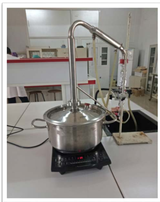
Figure 10 : L'extraction par entraînement à la vapeur (Photo originale, 2018).
