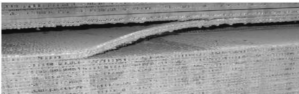
Figure II.8. Séparation de base due à la corrosion d'amalgames.
