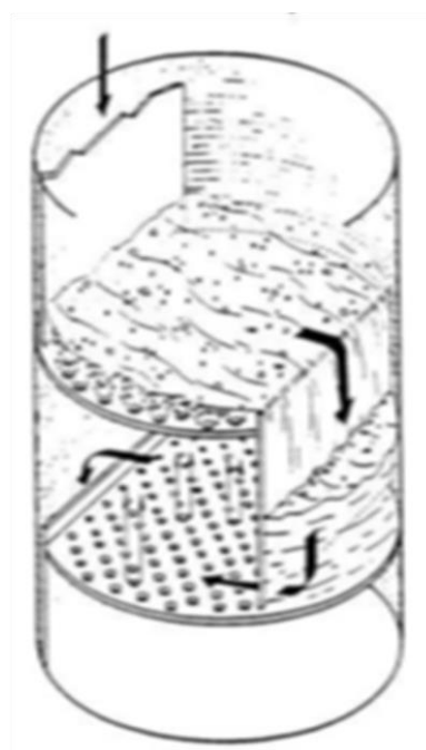
Figure II. 6. L'écoulement dans une colonne à plateaux
