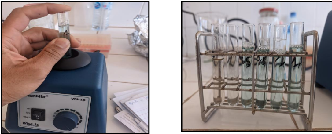
Figure 30 : Agitation des échantillons sur le Vortex
