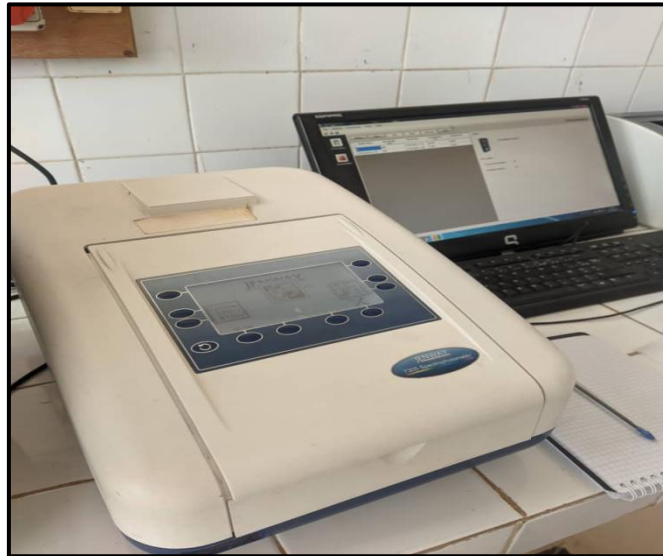
Figure 24 : Lecture des absorbances à l'aide d'un spectrophotomètre (Photo originale 2025).
