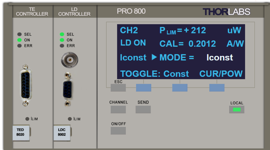
Figure III. 23 : Le changement du LDC8002 au mode puissance constante.
