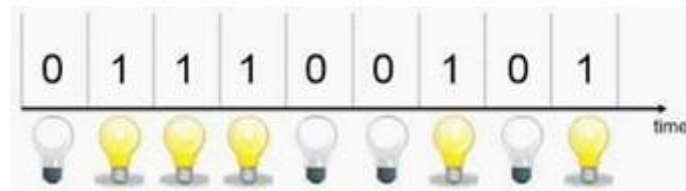
Figure 1.3. Principe de numérisation des données dans un système de communication VLC
