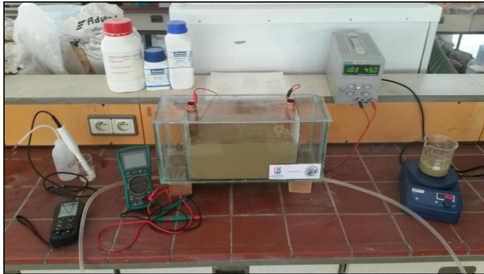
Figure IV.21. Le dispositif expérimental de la cellule électrochimique
