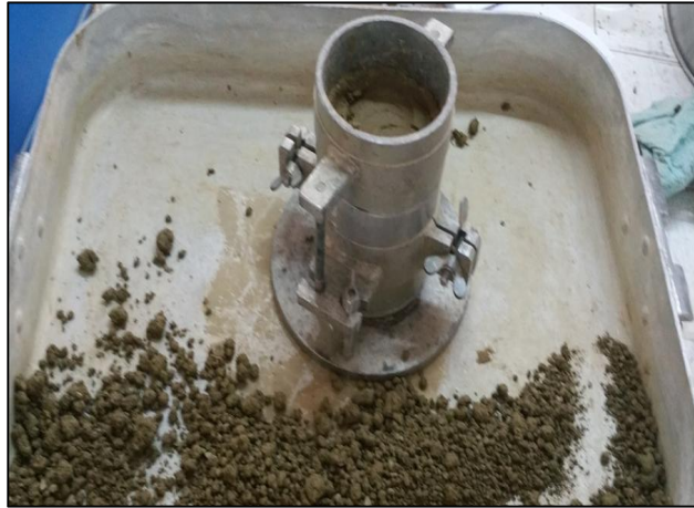
Figure IV.17. (a) L'essai de Proctor normal
