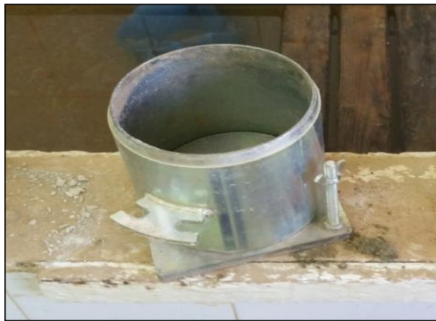
Figure IV.17.(b) Le moule CBR pour la réalisation du Proctor modifié
