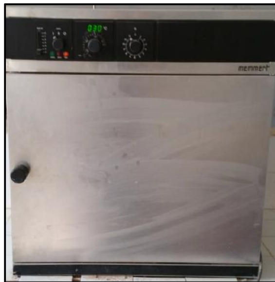
Figure IV.6. Le séchage des échantillons du sol à l'étuve
