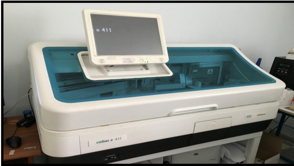
Figure N°8 : Automate pour analyses hormonologiques et immunologiques (Cobas e 411)
