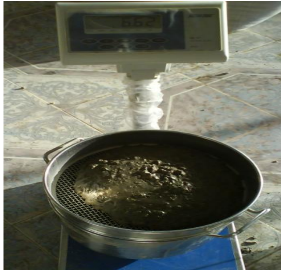
Figure III.3 : Aspect de l'essai de la stabilité au tamis
