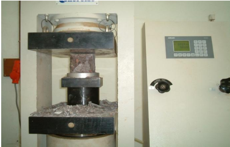
Figure II.15 : La presse utilisée pour les écrasements
