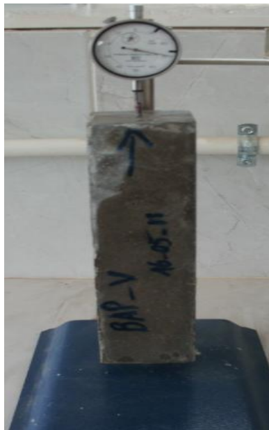
Figure II.20: Rétractomètre pour la mesure du gonflement sur une éprouvette de béton 7 \times 7 \times 28 \text{ cm}^3 .
