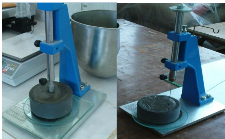
Figure II.5: Essais de consistance normale et de prise par l'appareil de Vicat
