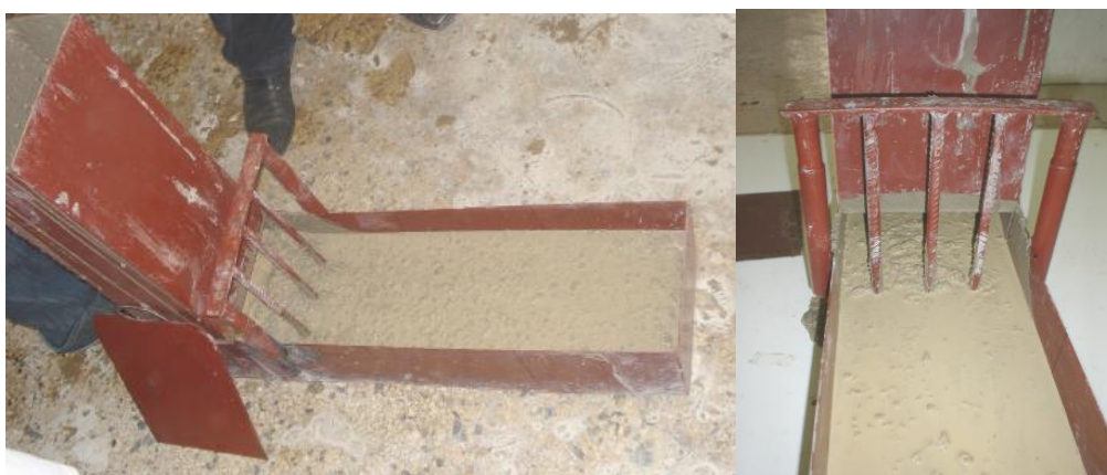
Figure III.2 : Aspect de l'essai de la boîte en L
