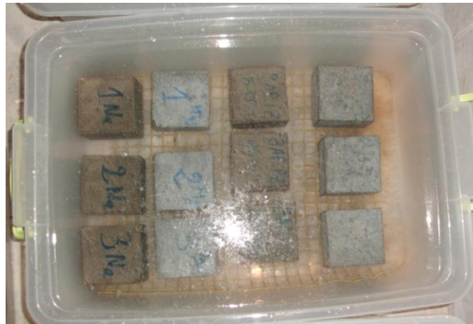
Figure II.18: Epreuves d'essais immergées dans une solution sulfatique.
