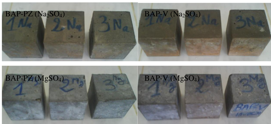
Figure III.16: Etats des surfaces des éprouvettes des BAP immergées dans différents milieux.
