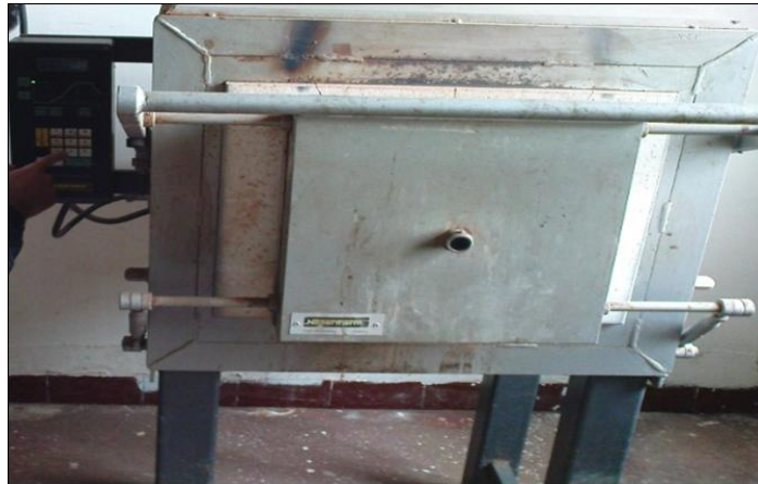
Figure II.1 : Four de calcination utilisé (+ 1200°C)
