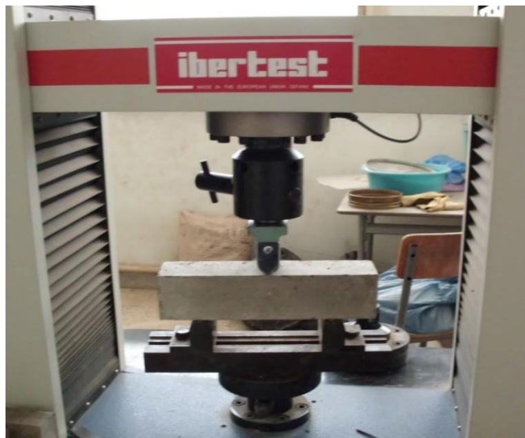
Figure II.16 : Presse munie d'un dispositif de flexion 3 points
