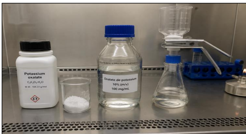
Figure 8 : Préparation de la solution mère d'oxalate de potassium à 10% (m/v).
