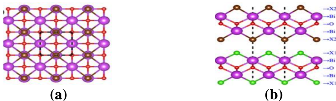
Figure I- 7 : Les structures atomiques relâchées de l'hétéro-couche \text{BiOX}_1 / \text{BiOX}_2 .(a) vue de haut niveau, (b) vue de côté. Les boules violettes, rouges, vertes et brunes représentent les atomes Bi, O, X_1 (I) et X_2 (Br) respectivement[107]
