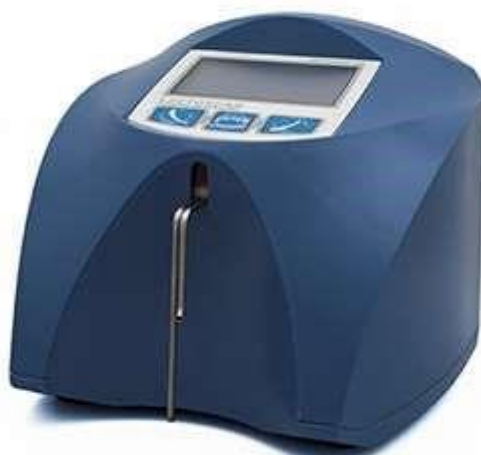
Figure 1:Lactoscan analyseur du lait en spectroscopie infra-rouge.
