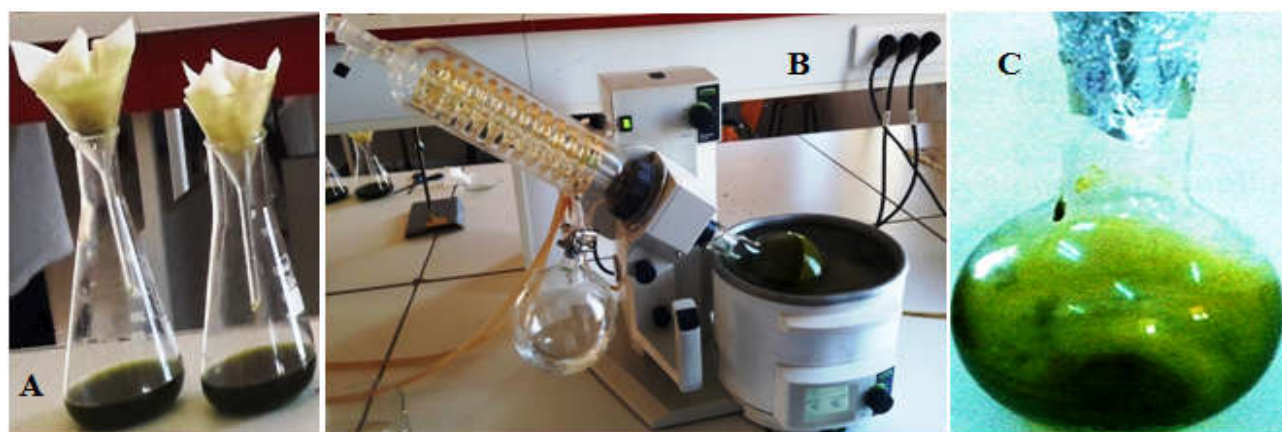
Figure 30 : A) L'extrait filtré sur papier filtre ; B) Rota vapeur utilisé pour le séchage des échantillons après l'extraction ; C) L'extrait végétal après séchage au Rota vapeur.
