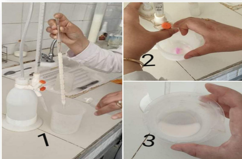
Figure IV.3. Le procédé de titrage.
