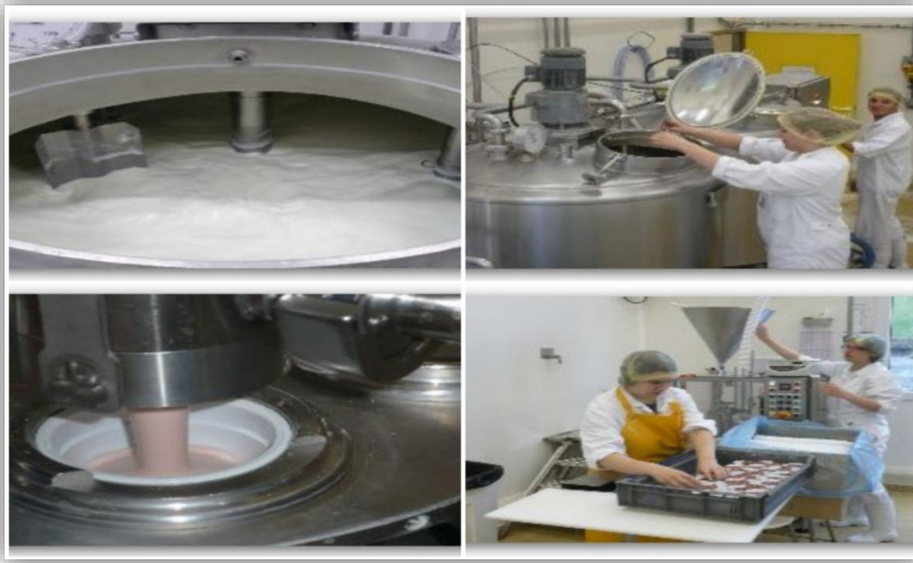
Figure IV.16. Les procédés de fabrication de yaourt.
