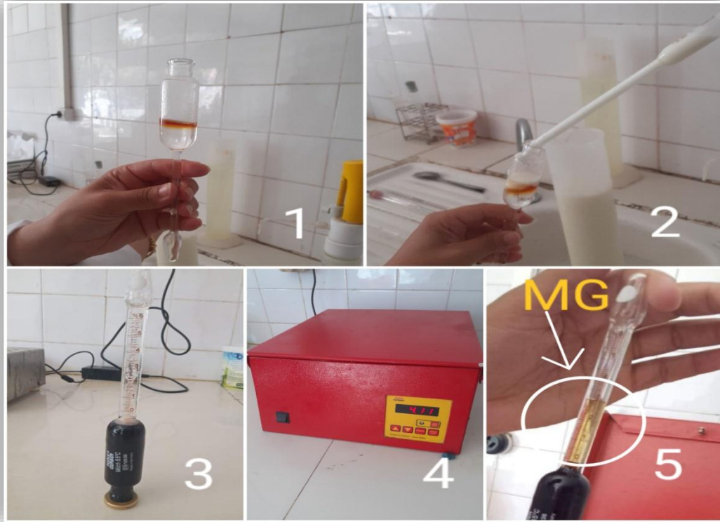
Figure IV.4. Méthode de mesure matière grasse.
