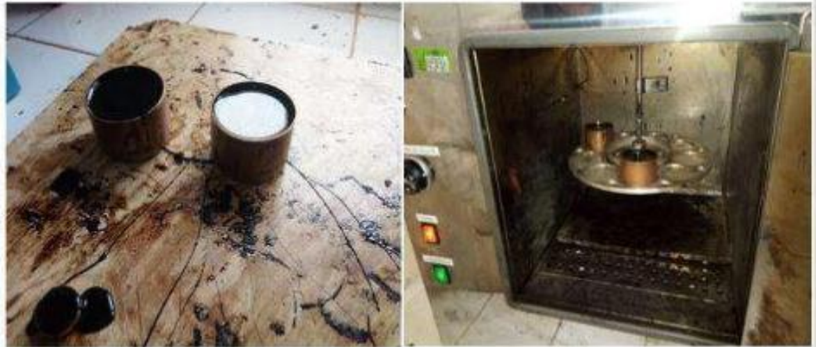
Photo II 3 : Essai de perte de masse au chauffage
