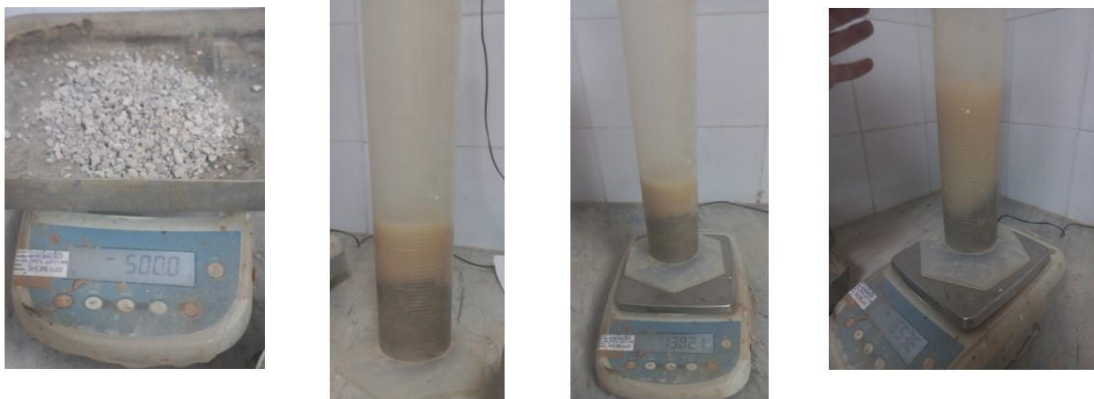
Photo II 9 : Essai de masse volumique des agrégats
