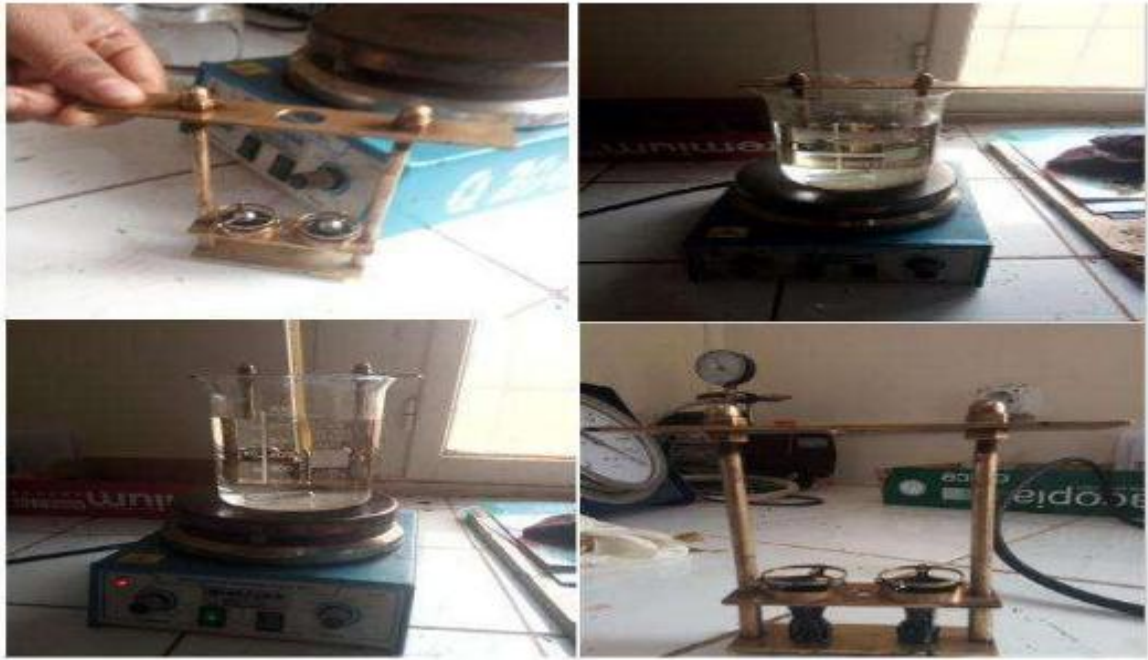
Photo II 2 : Essai de point de ramollissement
