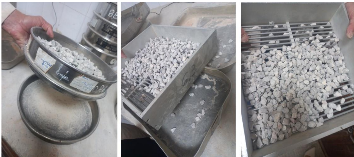
Photo II 5 : Essai de coefficient d'aplatissement
