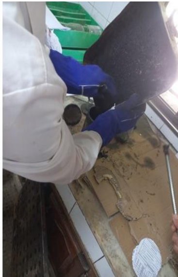
Photo II 22 : Versement du mélange dans les éprouvettes
