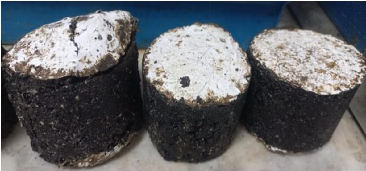
Photo III. 3: Éprouvettes d'enrobe contenant 4 % de PET à T=165 °C après rupture lors de l'essai Marshall
