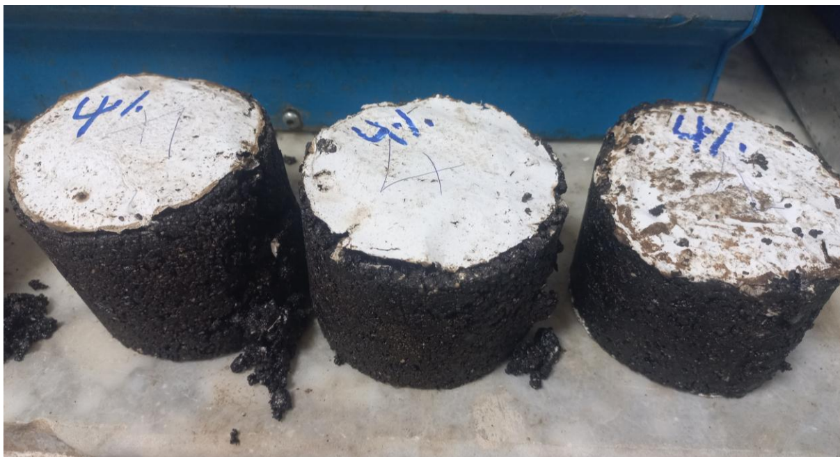
Photo III. 4: Éprouvettes d'enrobe contenant 4 % de PET à T=170 °C après rupture lors de l'essai Marshall
