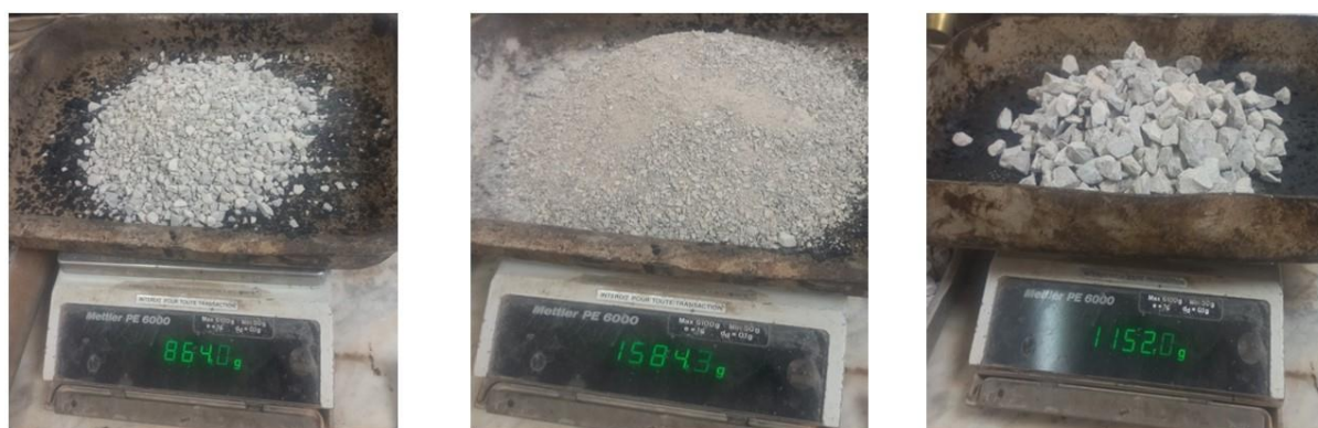
Photo II 18 : Préparation des agrégats pour la fabrication du mélange
