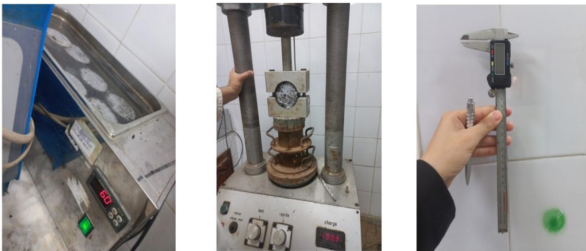
Photo II 24 / Préparation des éprouvettes au bain-marie, essai de stabilité Marshall et mesure du fluage
