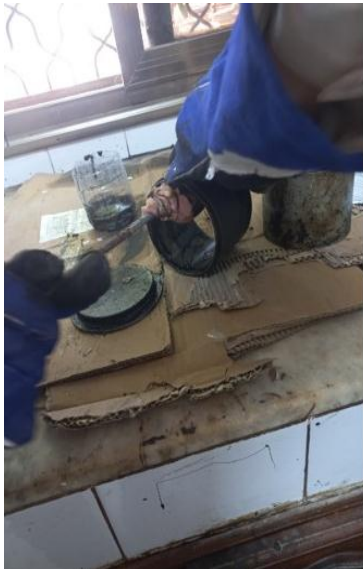
Photo II 22 : Versement du mélange dans les éprouvettes
