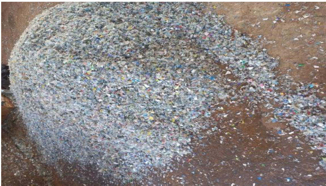
Photo II 13 : Séchage du plastique broyé
