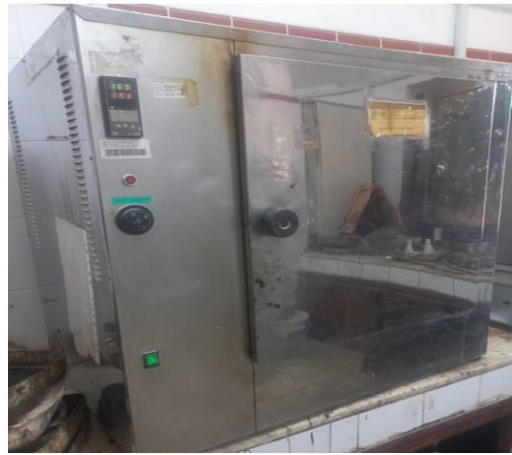
Photo II 19 : Etuve des agrégats et de bitume
