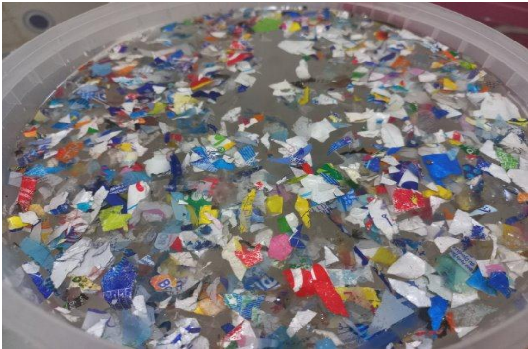
Photo II 15 : Trempage du plastique broyé dans une solution d'eau salée pour le retrait des étiquettes
