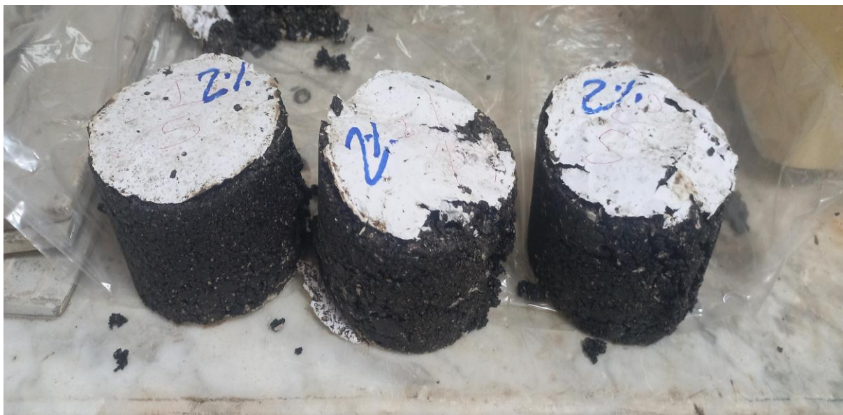
Photo III. 2: Éprouvettes d'enrobe contenant 2 % de PET à T=170 °C après rupture lors de l'essai Marshall
