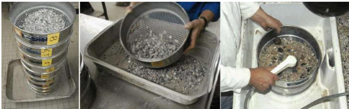
Photo II 4 : Equipement d'essai d'analyse granulométriques
