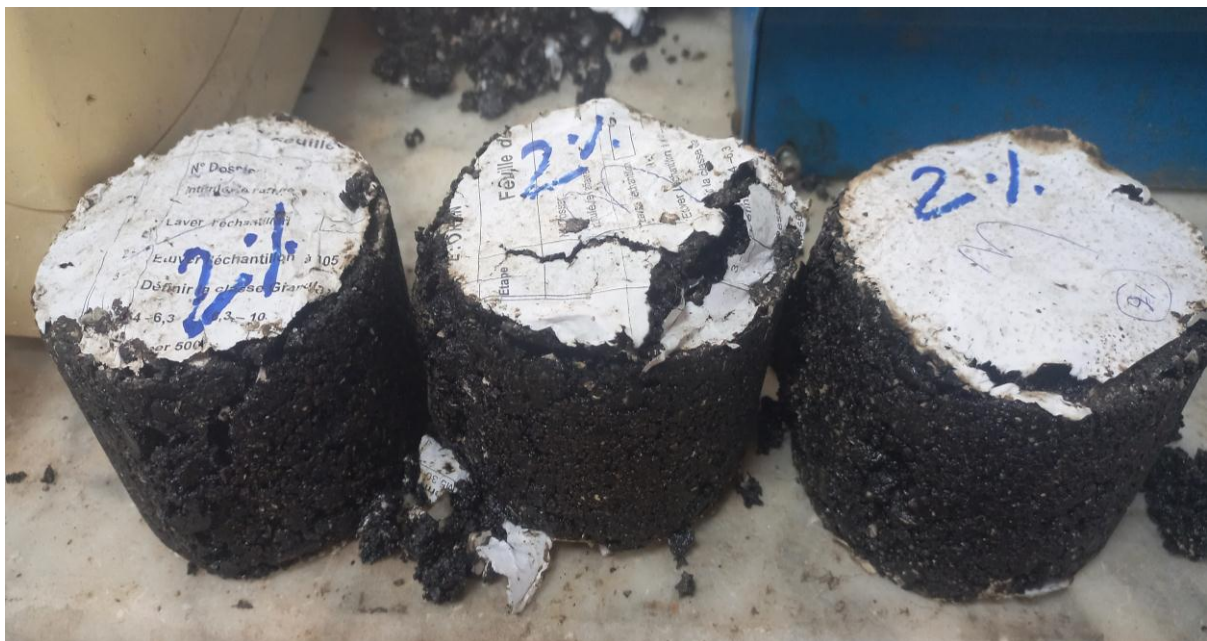
Photo III. 1: Éprouvettes d'enrobé contenant 2 % de PET à T = 165 °C après rupture lors de l'essai Marshall
