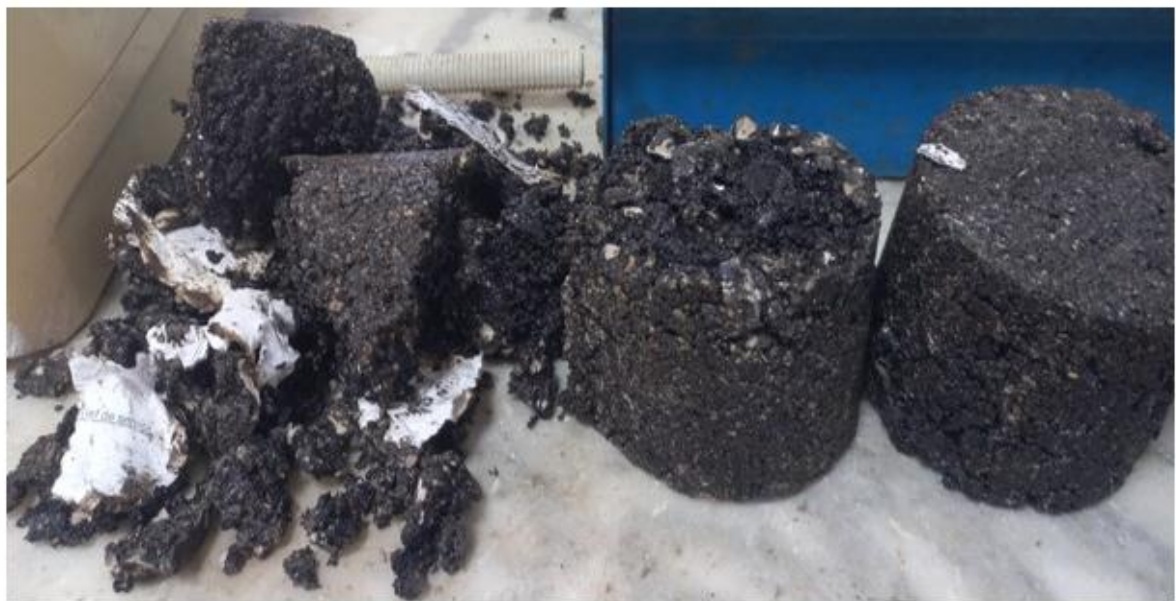
Photo III. 5: Éprouvettes d'enrobe contenant 6 % de PET à T=165 °C après rupture lors de l'essai Marshall
