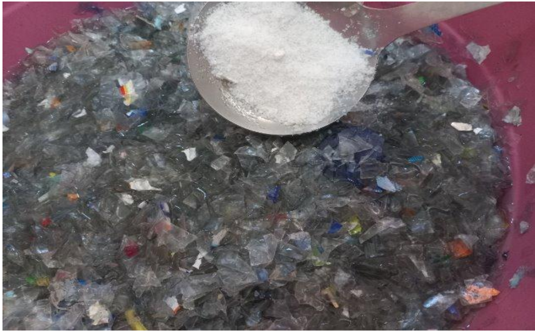
Photo II 14 : Résidus d'étiquettes observés après le broyage des déchets plastiques
