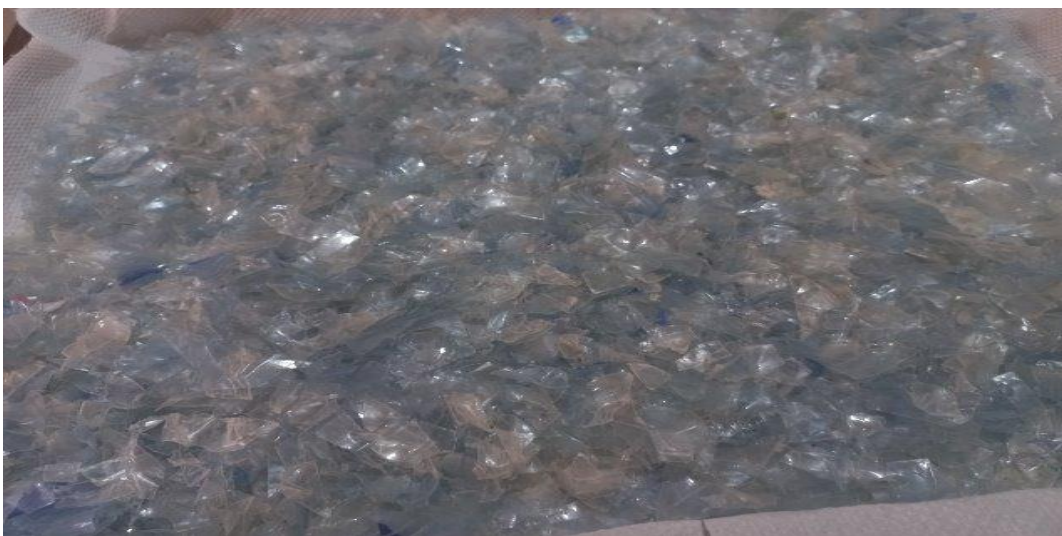
Photo II 17 : Séchage du plastique recyclé
