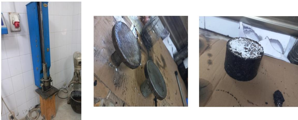
Photo II 23 : Compactage avec la presse Marshall et démoulage
