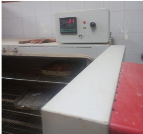
Photo II 19 : Etuve des agrégats et de bitume
