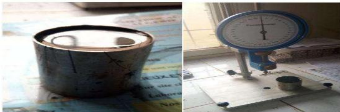
Photo II 1 : 1Essai de pénétrabilité aiguille
