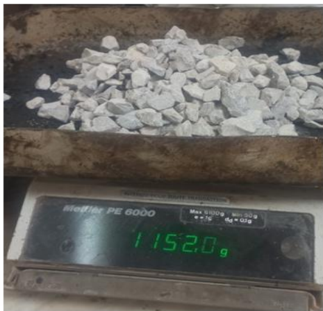
Photo II 20 : Mesure des agrégats et de bitume
