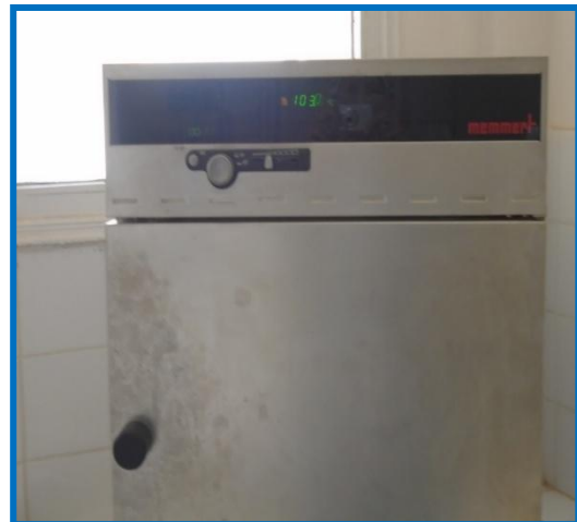
Figure n°21: Une étuve et un dessiccateur pour la détermination de l'extrait sec totale (Laboratoire CACQE Oran).
