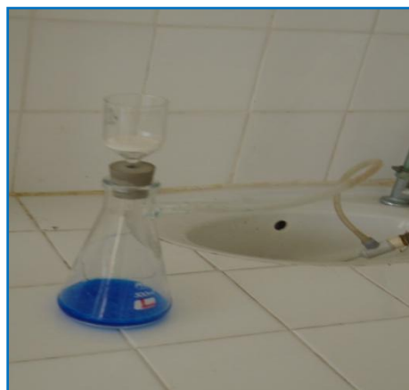
Figure n° 20: filtration de la liqueur surnageante sur un entonnoir filtrant en verre fritté N°4 (Laboratoire CACQE Oran )
