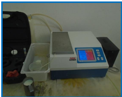
Figure n°12 : Le Lactostar FUNKE GERBER - laiterie Sidi Saada.
