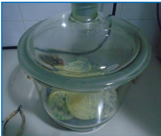
Figure n°21: Une étuve et un dessiccateur pour la détermination de l'extrait sec totale (Laboratoire CACQE Oran).
