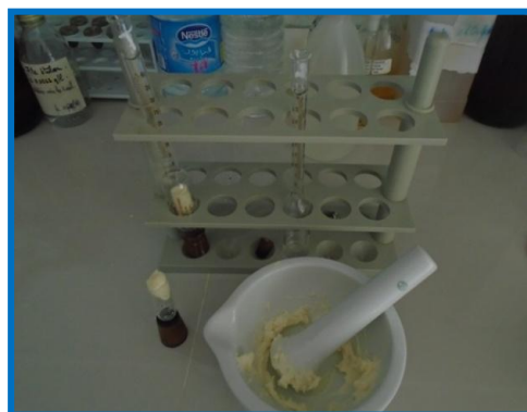
Figure n°22 : Préparation de la prise d'essai pour le dosage de la matière grasse à l'aide d'un butyromètre
