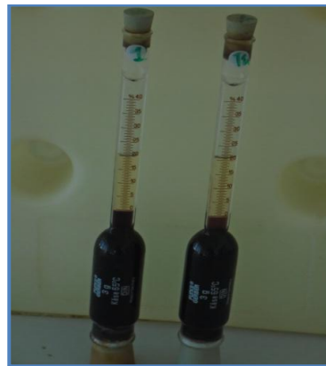
Figure n° 27: La lecture de la matière grasse de deux échantillons de camembert sur le butyromètre.
