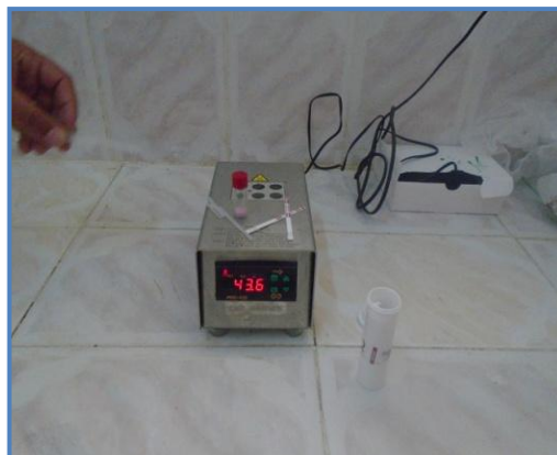
Figure n°13 : Le test de Beta Star Combo pour la recherche des antibiotiques dans le lait cru (La salle de réception du lait cru au niveau de la Laiterie Sidi saada )
