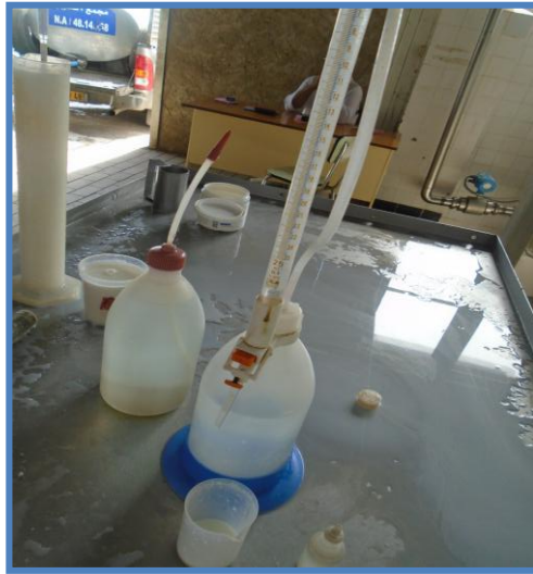
Figure n° 19: Un acidimètre (Laiterie Sidi saada ).
