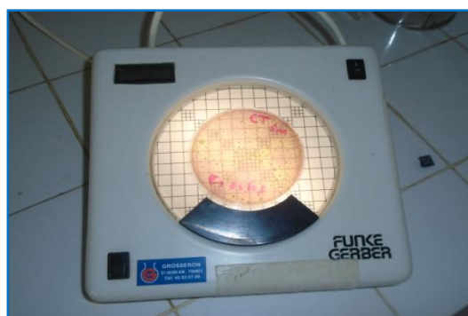
Figure n° 25 : Lampe pour lecture de colonies type FUNKE GERBER (Laboratoire de laiterie Sidi Saada)
