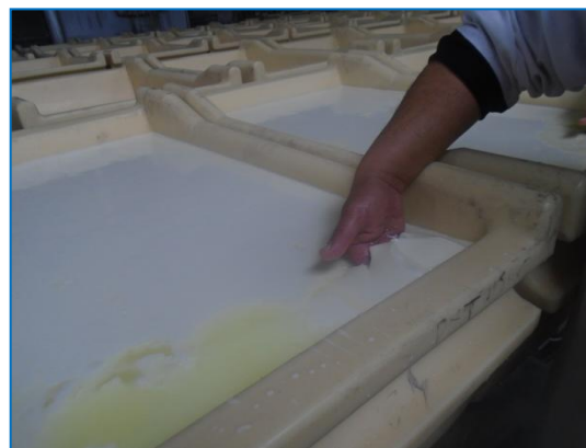
Figure n° 5: Le durcissement du caillé de lait (La section fromagerie Sidi Saada).
