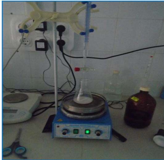
Figure n° 24: Dispositif du dosage des protéine dans le camembert (Labratoire O.C Relizane)
