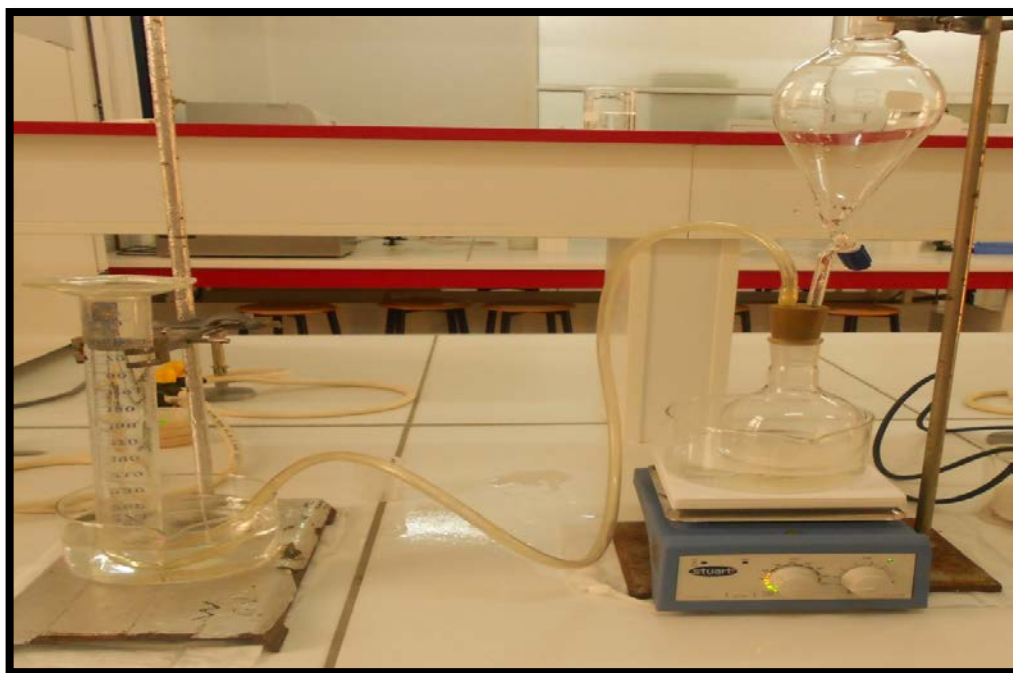
Figure N° 18: Dispositif de mesure du CO 2 produit permettant la collecte du gaz (Pol, 1996).
