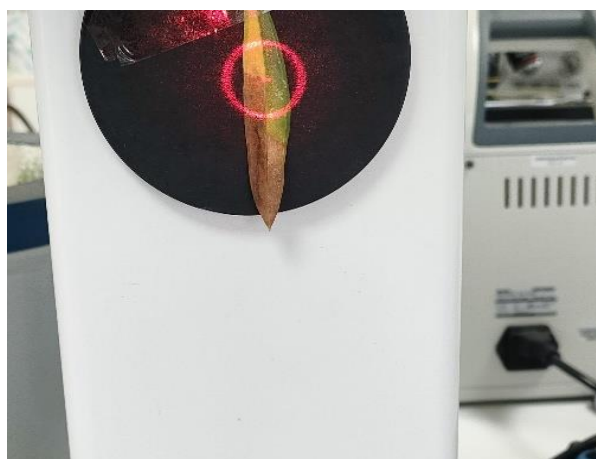
Figure 25 : L'appareil JETI SpectraVal 1501 pendant la prise des mesures dans le laboratoire de recherche « protection des végétaux ».
