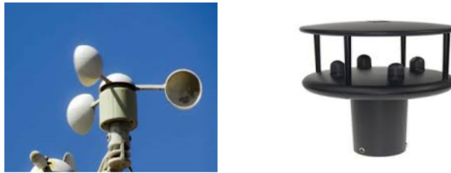
FIGURE 6.5 – Anémomètre à demi-sphères et à ultrasons
