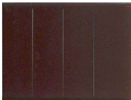
FIGURE 5.14 – Cellule photovoltaïque amorphe (couleur brun-rougeâtre à bleu-violet).
