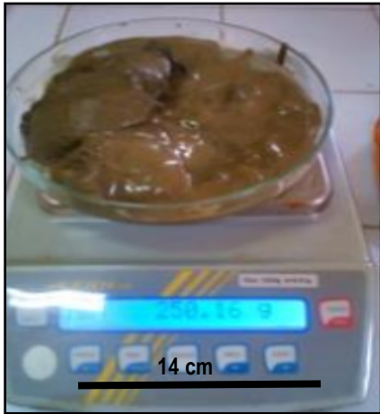
Fig. 8 : Pesage du sédiment humide.
