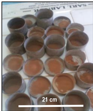
Fig. 18 : La phase de refroidissement à l'aide de dessiccateur.
