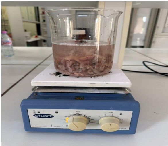
Figure 13 : Chauffage de la chair des poissons sur une plaque chauffante à 90°C.
