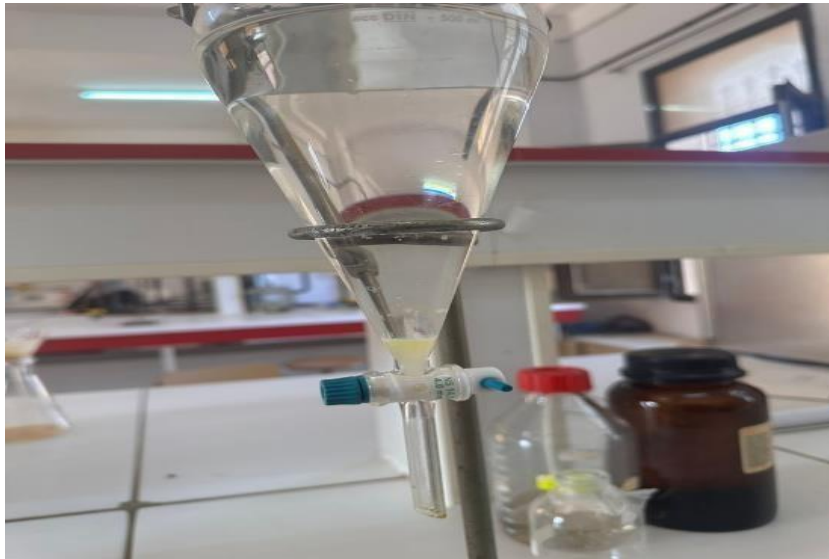
Figure 9. Mat riel de la d cantation
