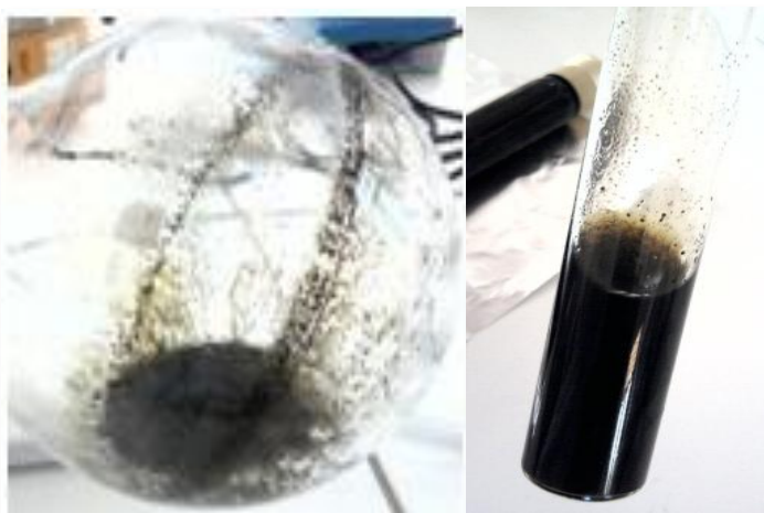
Figure 14 : Extrait polyphénolique récupéré par extraction Soxhlet
