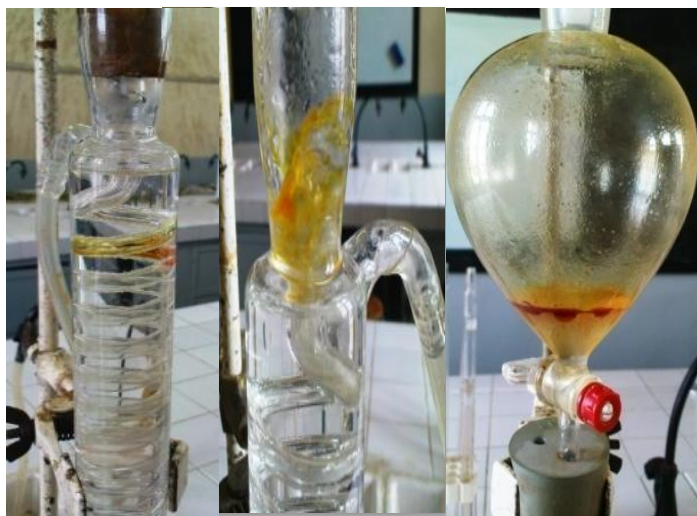
Figure 13 : Huile essentielle de thym récupérée par hydrodistillation.
