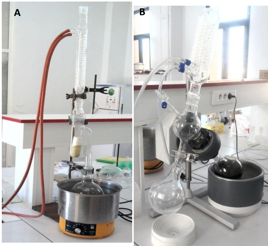
Figure11: Dispositifs d'extraction Soxhlet (A) et d'évaporation du solvant extractant (B).
