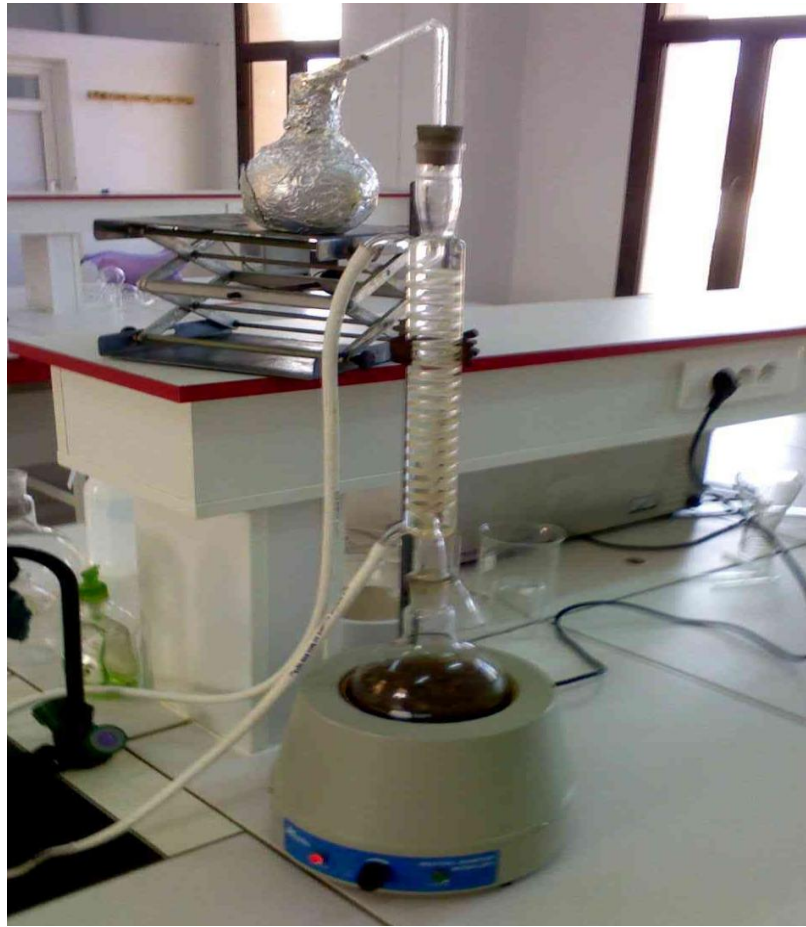
Figure 12: Dispositif de l'extraction par hydrodistillation
