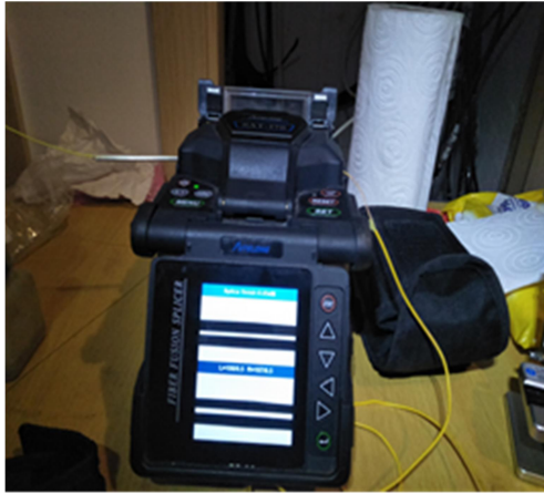
Figure 4.47 : Fusion des fibres.
