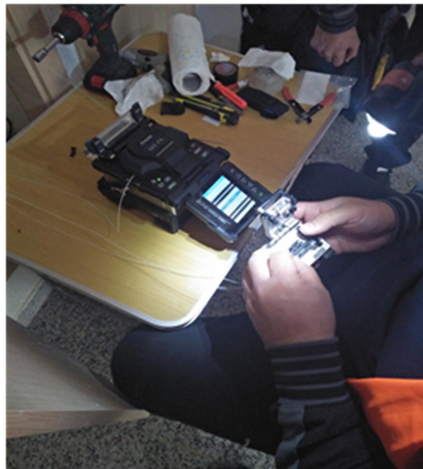
Figure 4.44 : Clivage de la fibre.
