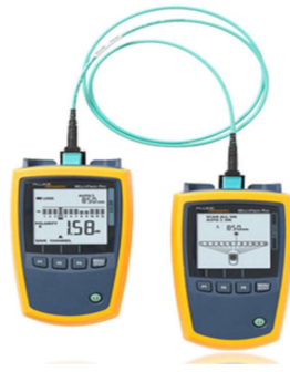
Figure 4.51 : Montage pour mesurer les pertes de puissance avec un power-mètre.
