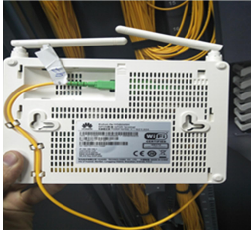
Figure 4.39 :L'ONT connectée via le connecteur SC.
