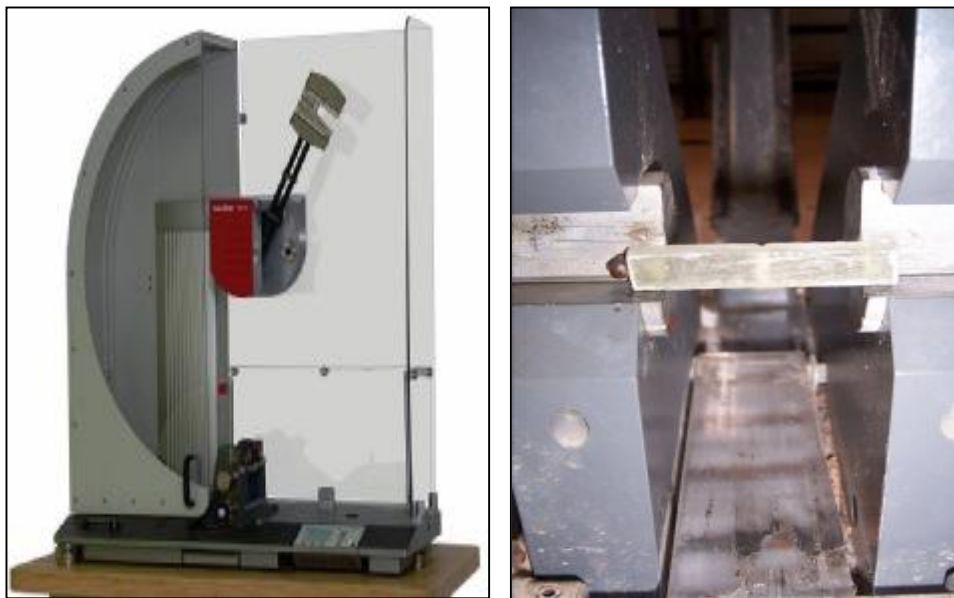
Figure III.16. Disposition de l'éprouvette dans la machine
