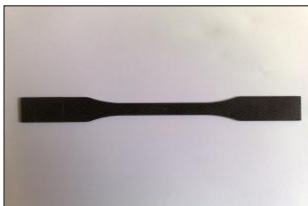
Eprouvettes en forme (a). (forme d'haltère)
