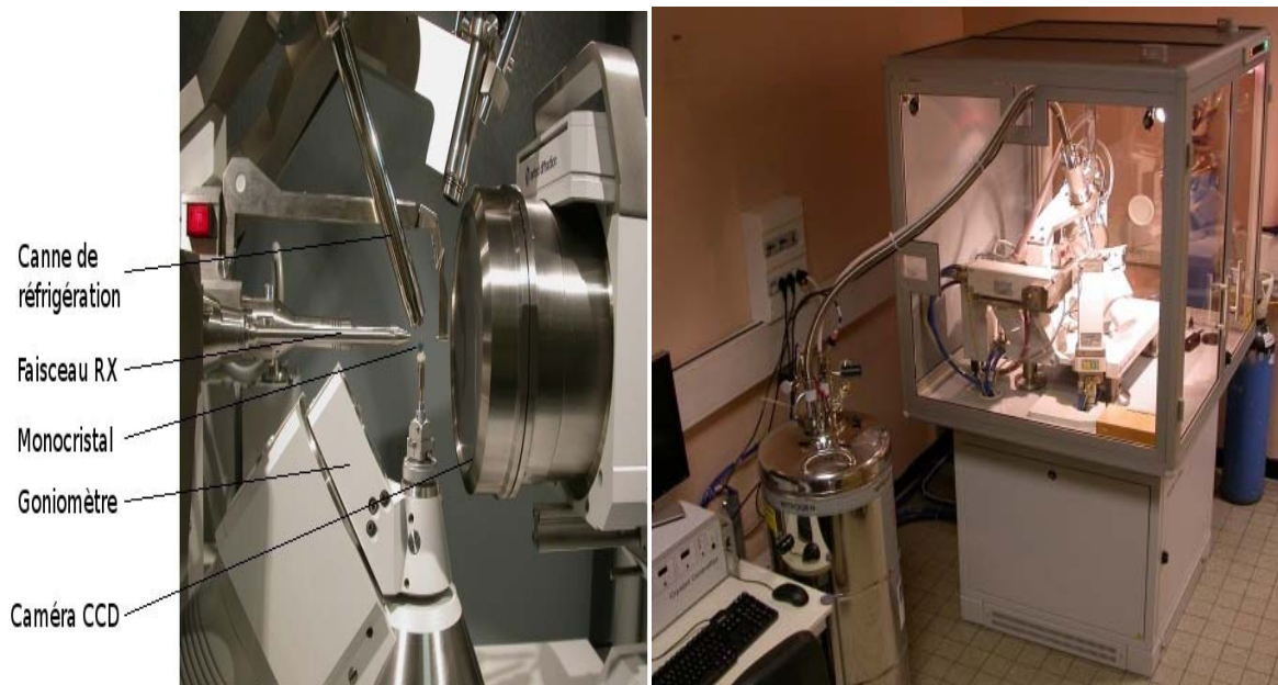
Figure II.10. L'appareil utilisé pour réaliser DRX.
