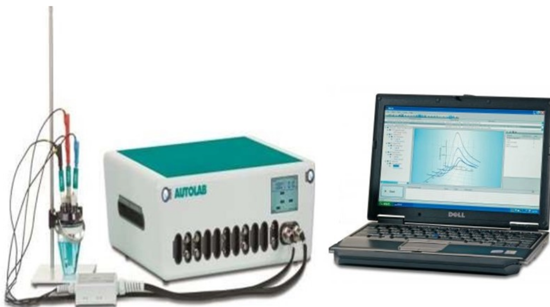
Figure III. 13: Montage expérimental utilisé pour les mesures électrochimiques.
