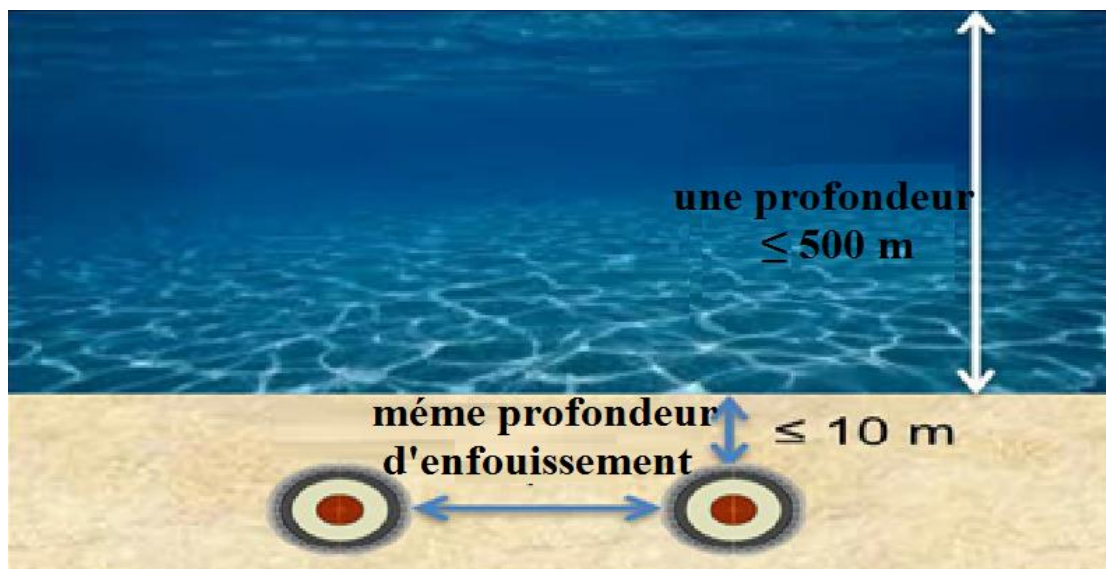
Figure 3.6 Installation de câbles sous-marins HVDC a une profondeur moins de 500m
