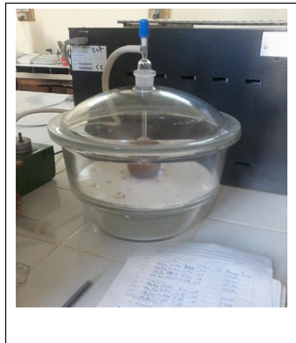
Détermination de la densité réelle par Pycnomètre
