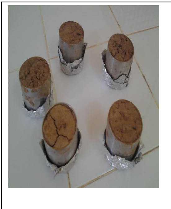
Détermination de la densité apparente par le cylindre
