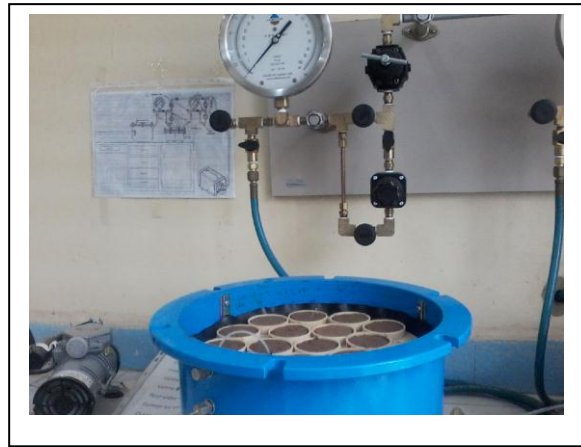
Dispositif de Richard pour la détermination des pF
