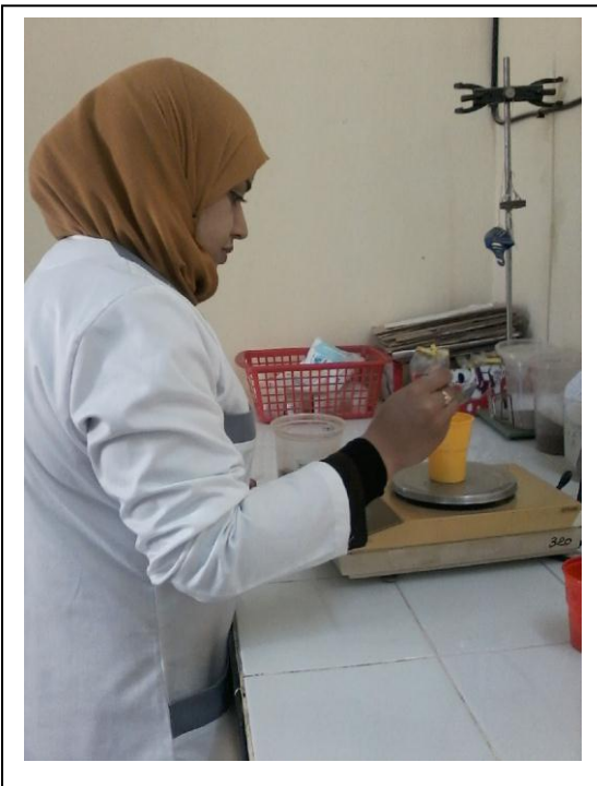
Pesée des échantillons de sol
