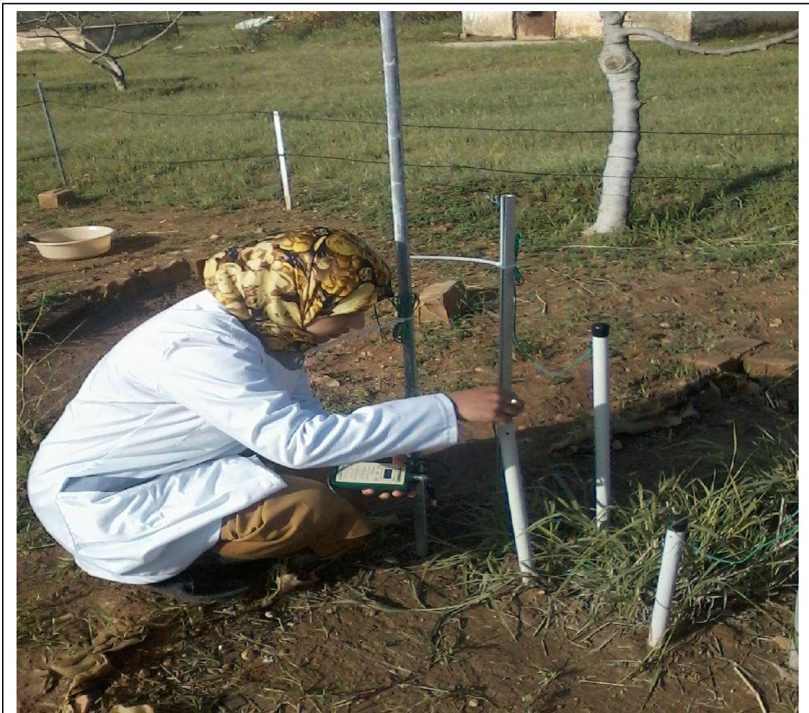
- Tensiomètres « Water Mark » installés au niveau du site expérimental
