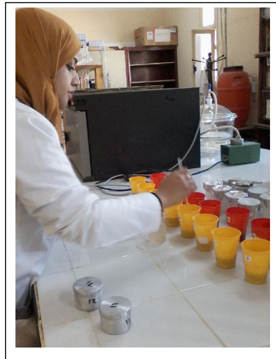
Agitation des échantillons de sol
