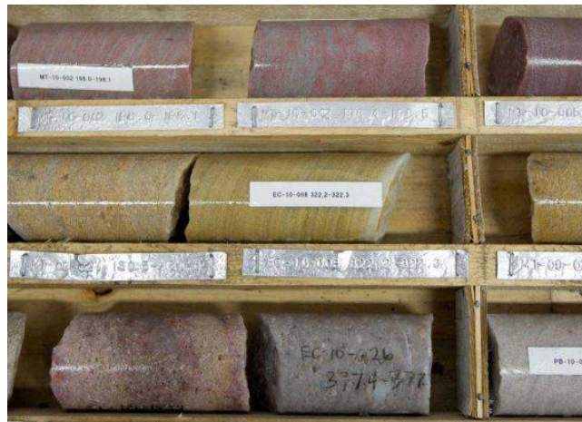
Figure n°47 : exemple d'un essai de carottage.
