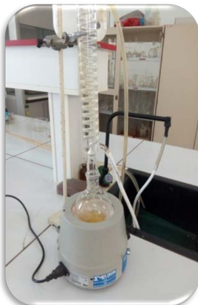
Photo 4. Dispositif de chauffage à reflux.
