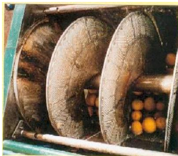
Figure 24. Dispositif de l'extraction par expression à froid
