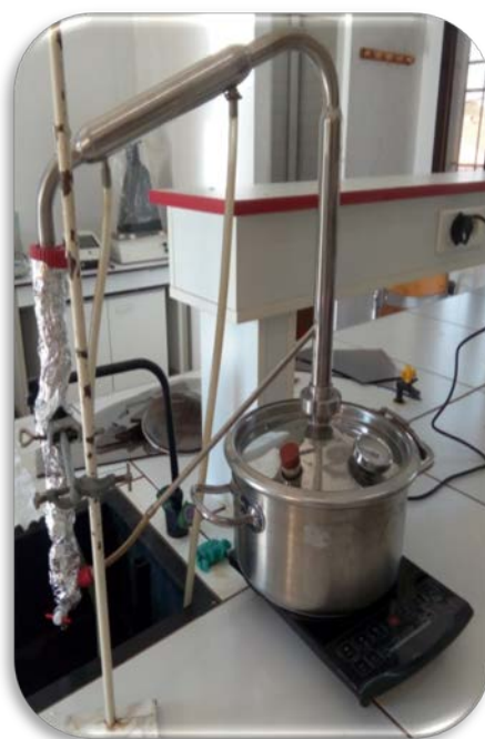
Photo 2. Dispositif utilisé pour l'extraction de l'HE du citron.
