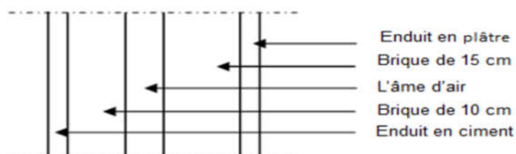
FIGURE 2.10 : COUPE VERTICAL DE MUR EXTERIEUR
