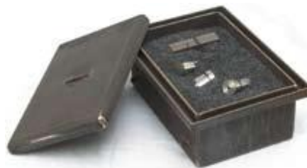
Fig. III.2 : Mise en caisse des échantillons à cémenter [73]
