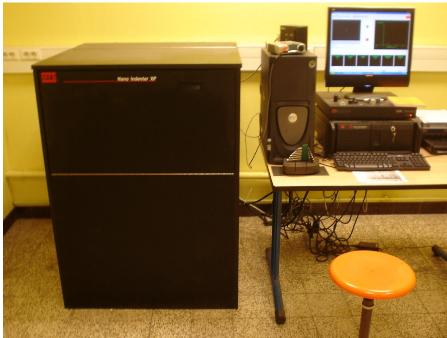
Fig. III.18 : Vue générale du NanoIndenteur XP MTS
