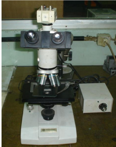
Fig. III.8 : Microscope optique utilisé pour mesurer l'épaisseur de cémentation
