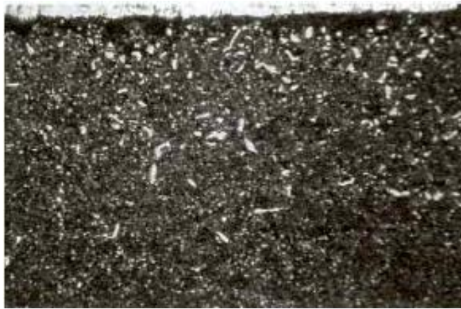
Fig. I.13 : Carbures en nodules (blancs) en surface sur fond martensitique (Attaque Nital 2%, grossissement 280)
