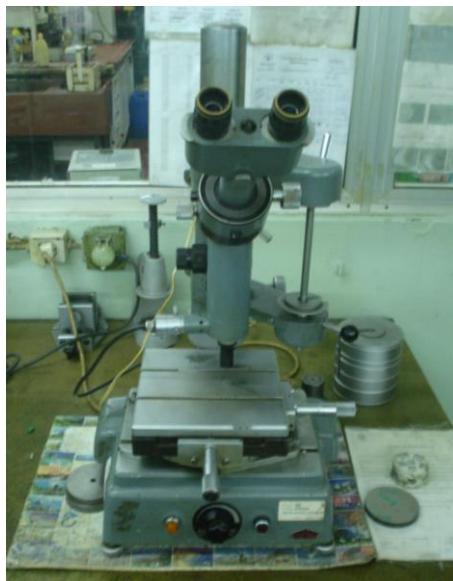
Fig. III.9 : Microduromètre utilisé pour mesurer la dureté des couches cimentées
