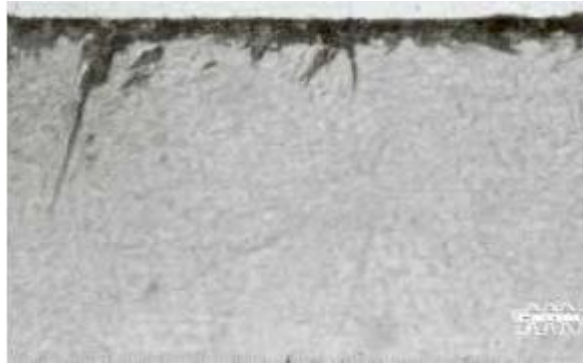
Fig. I.12 : Oxydation interne sur fond de martensite et d'austénite résiduelle (Attaque Nital 4%, grossissement 280)
