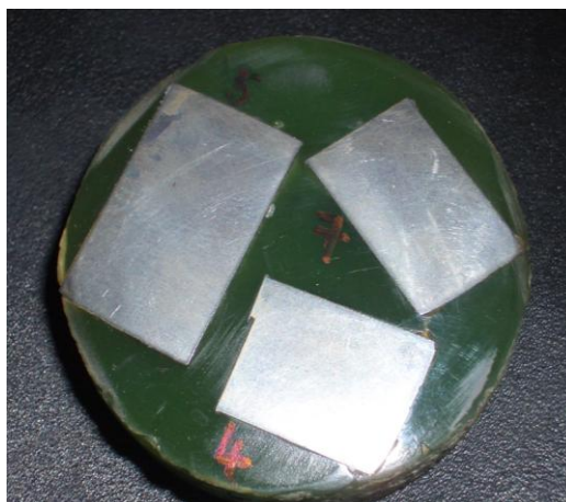
Fig. III.7 : Echantillons cimentés, découpés, enrobés et polis
