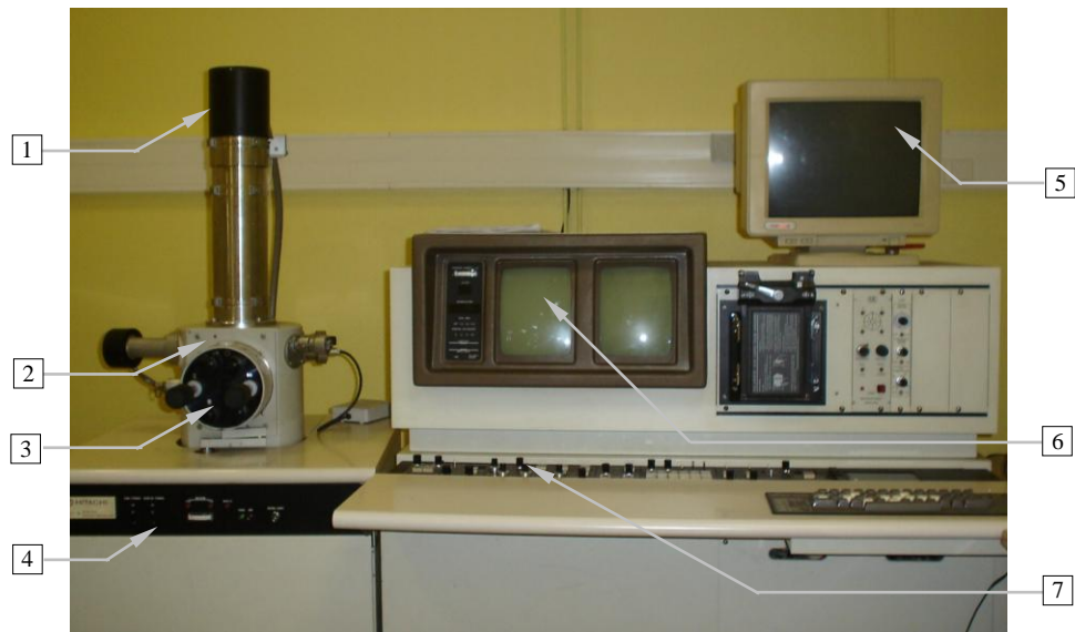
Fig. III.14 : Microscope Electronique à Balayage (MEB) utilisé pour déterminer la morphologie des dépôts obtenus
