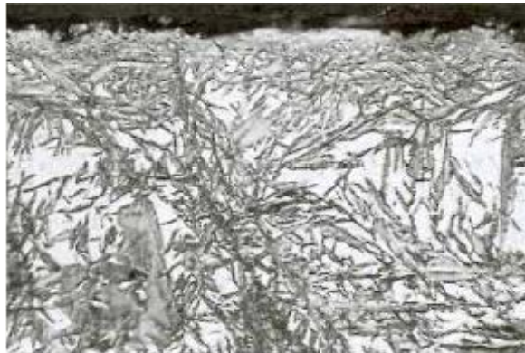
Fig. I.11 : Austénite résiduelle dans une couche cémentée et durcie par trempe (Attaque Nital 4%, austénite blanc, martensite chamois, grossissement 280)
