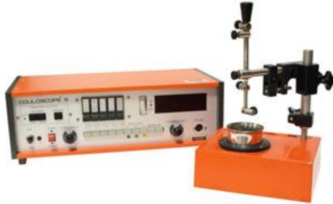
Fig. III.10 : Couloscope destiné à mesurer l'épaisseur de chromage
