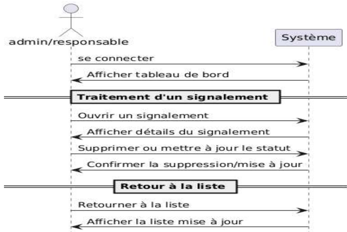
Figure 2.121: Diagramme de séquence Gérer signalements
