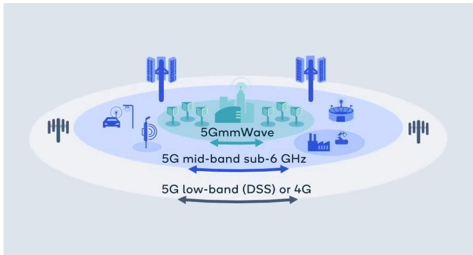
Figure II-1: Les deux groupes de fréquences utilisés par la 5G NR[1]
