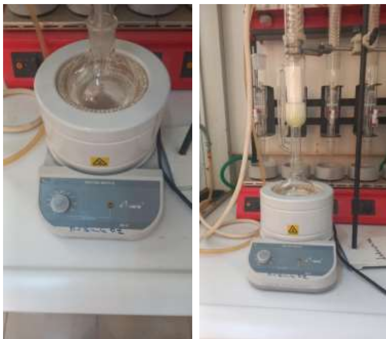
Figure. 05: Dispositif Soxhlet utilisé pour l'extraction des lipides (Belarbi 2025)
