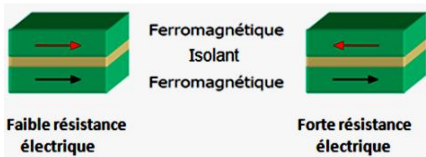
Figure I.14 : les deux états, parallèle et antiparallèle, dans une jonction tunnel magnétique
