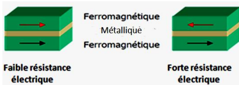
Figure I.13 : les deux états, parallèle et antiparallèle, dans une jonction géante magnétique.
