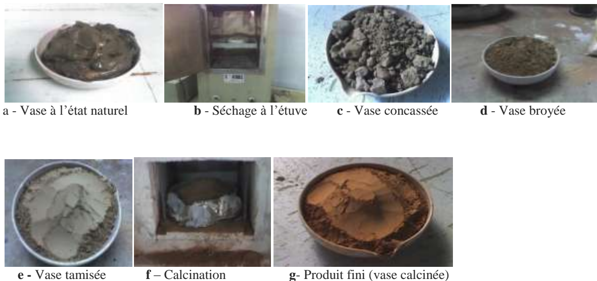
FIG. 1 - Etapes de préparation de la vase draguée
