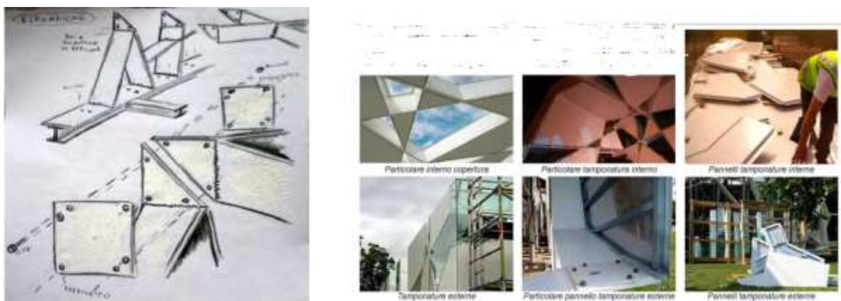
Figure 123 : Croquis de remplissage : panneau externe, panneau interne, ancrage à la structure portante - Brontolo Group
