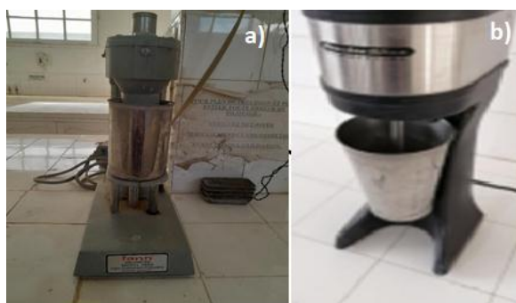
Figure II.10: Appareillages de mesure la viscosité (a. Viscosimètre, b. Agitateur.).
