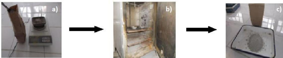
Figure II.13: Méthode d'analyse de l'humidité.
