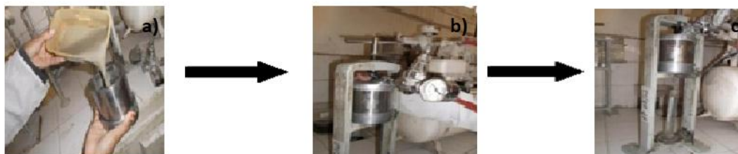
Figure II.16: Méthode d'analyse du volume de filtrat.
