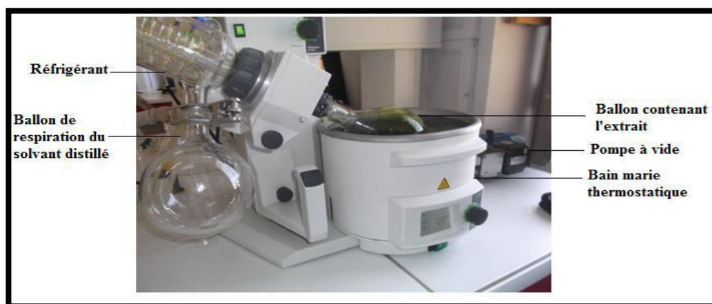
Figure 27 : Dispositif d'évaporation rotatif (Originale, 2016)
