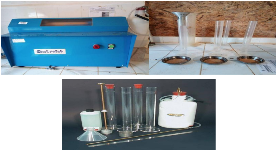
Photo I.8 : Matériels utilisés dans l'essai équivalent de sable.
