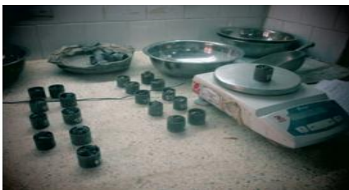
Figure I.2. : Matériels d'essai teneur en eau
