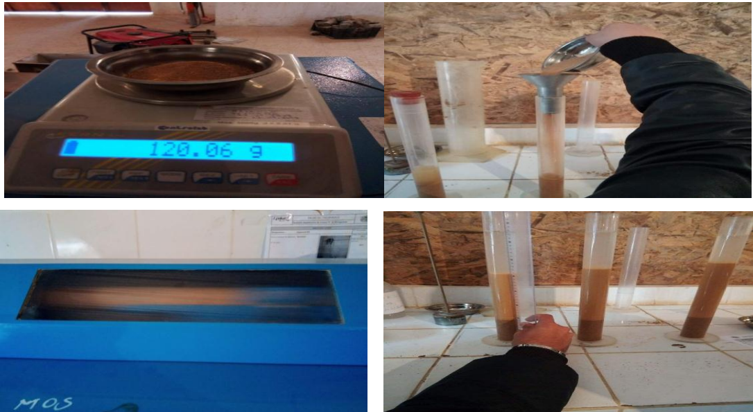
Photo I.9 : Essai d'équivalent de sable
