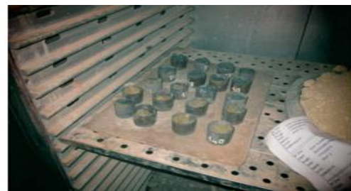
Figure I.2. : Matériels d'essai teneur en eau
