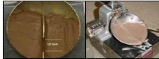
Photo VI.9: Fermeture des lèvres sur \pm 1 cm après application de chocs à la coupelle
