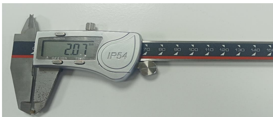
Figure 20: Mesure du diamètre des capsules à l'aide d'un pied à coulisse numérique
